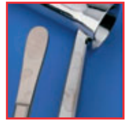
Durulama suyundaki yüksek tuz oranından dolayı oluşan lekeler
