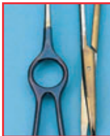
Silisik asitten dolayı renkleri değişmiş aletler
