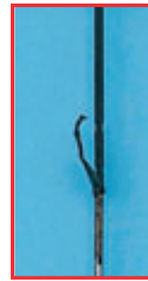
Bir HF aletinde hasar görmüş izolasyon
