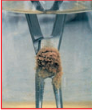
Serum fizyolojik içine birkaç saat daldırmaktan kaynaklanan pas oluşumu
