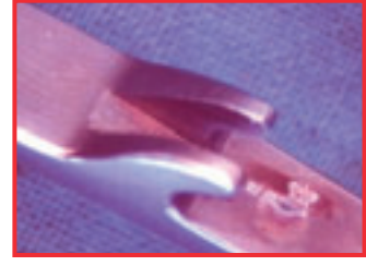
Yaydan kaynaklanan sürtünme yeri olan iğne tutucu branşı
