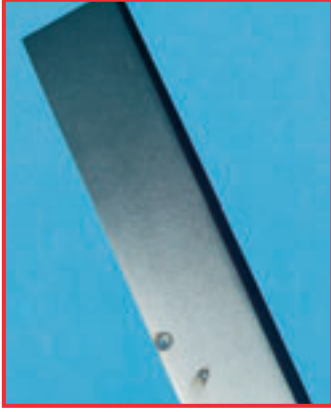
Keski üzerinde korozyon aşınması
