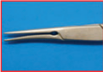
Usulüne uygun olmayan kullanımdan dolayı deformasyon
