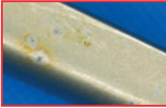
Alet üzerinde kloridle indüklenen oyuklaşma korozyonu
