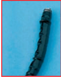
Bir fibreskopun distal ucunda şişme
