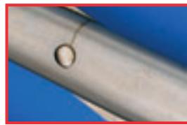
Bir makasın vida dişi yerinde kılcal çatlaklık
