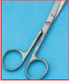
Oyuklaşma korozyonlu makas
