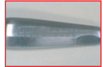
Yetersiz durulamadan dolayı deterjan artıklarının taşınması
