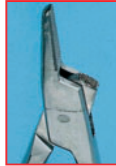
Tungsten karbit ięne tutucu ağız kırılması
