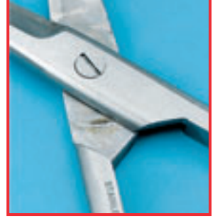
Yağla bakım yapılmadığından dolayı sürtünme korozyonu
